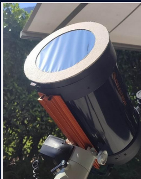
Abbildung 1: Selbstgebauter Sonnenfilter. Er besteht aus zwei Pappringen, die mit doppelseitigem Klebeband auf eine 3D-gedruckte Halterung geklebt sind. Diese rastet im originalen Celestron-Verschlussmechanismus ein und verhindert so ein versehentliches Herunterfallen.
